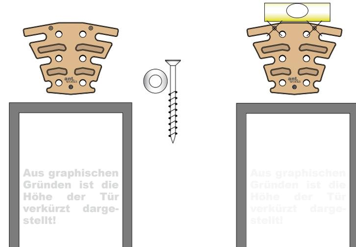
Schraube das Power Ant Mini mit einem 40er Torx Schraubendreher soweit fest, dass das Combiboard noch gedreht werden kann.
