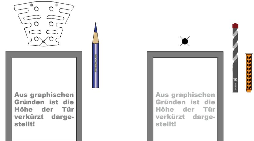
Markiere den unteren Punkt des Boards an der Wand (vorzugsweise über einem Türstock) an der Du das Power Ant Mini anbringen willst.
